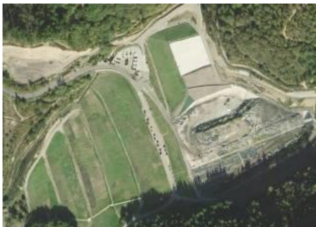
Instalación de gestión de residuos con vaso sellado (izquierda) y vaso en explotación
