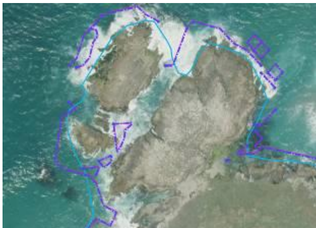
Curva de cota 0 obtenida con MDT (morado) y línea de costa en cota 0 resultante (azul)
